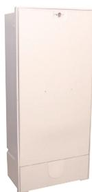
Ces coffrets peuvent se poser sur tige de scellement sur muret, sur poteau ou sur socle S20 (+ 515 mm hauteur hors-sol) en zone inondable par exemple. Ils peuvent recevoir un support barres REMIC de 300 mm.
